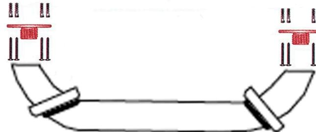
4- Afaste um pouco a canopla c/ a borracha para posicionar a barra com o conector na parede
